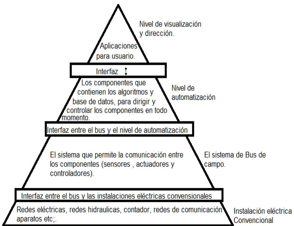
Figura 2.3: Pirámide de los Niveles en la Automatización de edificios y viviendas.
